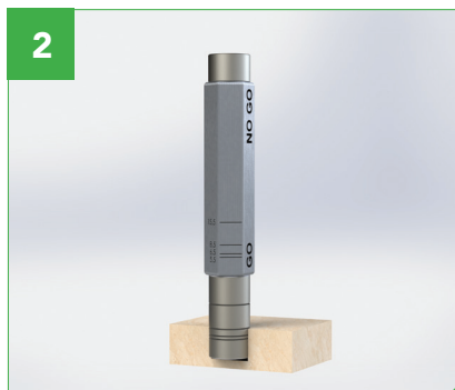
2 Verifique la ejecución correcta del orificio con el calibre pasa/no pasa. Check the correct hole size with the Go/No Go gauge. En el lado 'GO' (pasa) del calibre, están previstas marcas para controlar la profundidad exacta del orificio en relación con la longitud del inserto IM que se va a utilizar. On the Go side of the gauge there are reference marks to check the correct hole depth.
