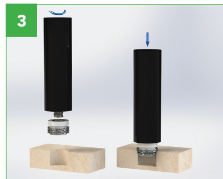
3 Para una correcta colocación, atornille el inserto IM en el mandril roscado hasta el tope. For correct installation, screw the IM insert onto the threaded mandrel up to the stop. Realice la introducción a través de presión. Press the insert in.
